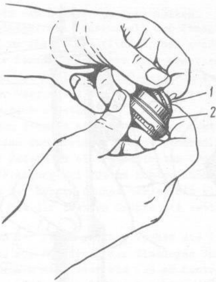
Bild 4-55. Entfernen der Dichtung aus Führung: 1 - Dichtung der Führungsstange; 2 - Stangenführung
