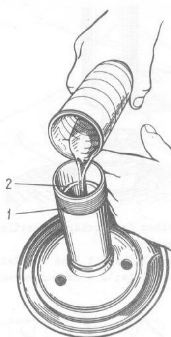
Bild 4-36. Einfüllen von Stoßdämpferflüssigkeit: 1 - Behälter; 2 - Arbeitszylinder
