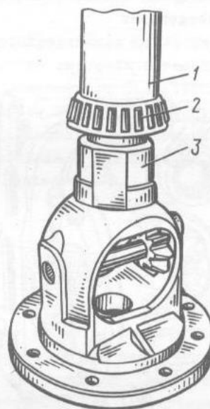
Bild 3-139. Auftreiben der Lager des Ausgleichgetriebes: 1 - Dorn; 2 - Lager; 3 - Ausgleichgetriebegehäuse
