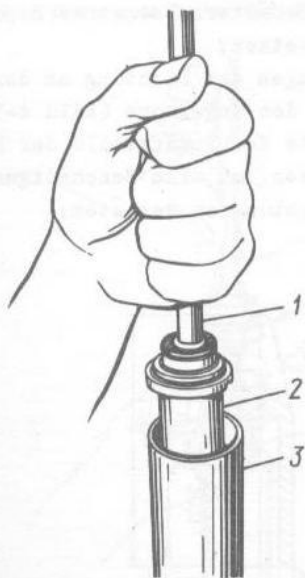
Bild 4-52. Anheben der Kolbenstange im Satz mit Arbeitszylinder über Behälter: 1 - Kolbenstange; 2 - Arbeitszylinder; 3 - Behälter
